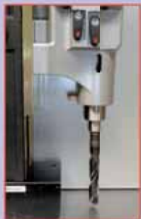
Vollbohren mit MK3-Adapter Twist drilling with MT3-adapter
